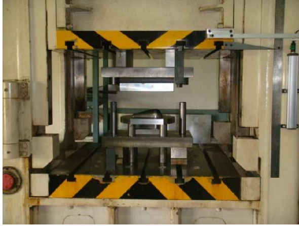
Fig. 5 Installation of die on 80 ton hydraulic press
